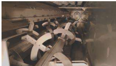
Das Horizontale Rührwerk sorgt für eine Permanente Durchmischung und für eine große Oberflächenbildung.
